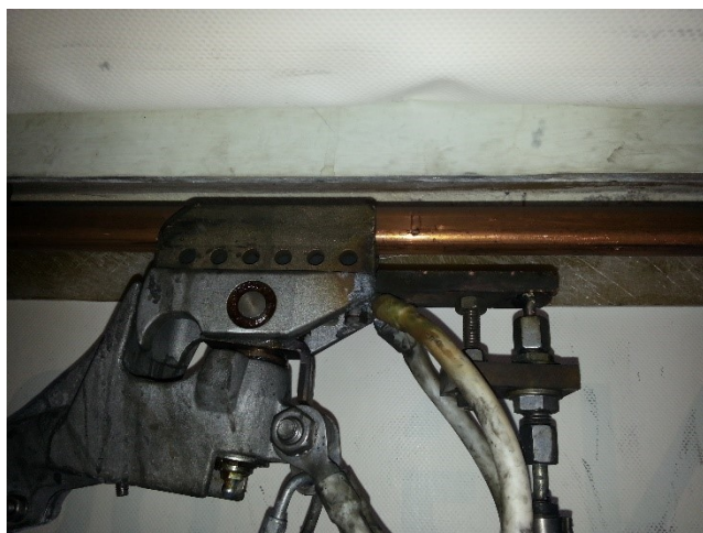
Système de pulvérisation adapté sur le Pantographe
